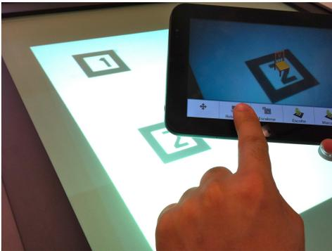
Figura 11: Controle dos modelos tridimensionais e marcadores através do dispositivo móvel. Usuários podem customizar a interação remotamente.
