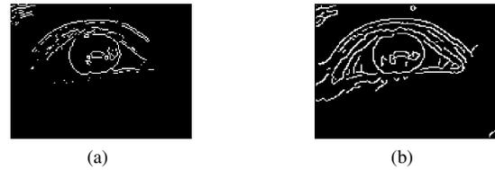
Fig. 4. Detecção de bordas pelos filtros de (a) Sobel e (b) Canny
