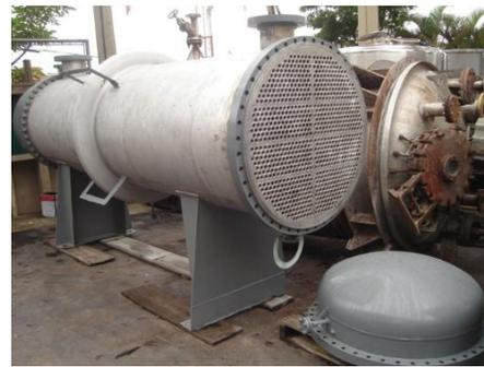
Figura 1. Trocador de calor de casco e tubo com o cabeçote aberto para manutenção.
