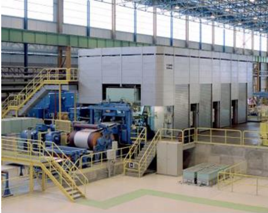
Figura 2-5 – Laminador a Frio em Tandem de Quatro Cadeiras da ArcelorMittal Vega 6
