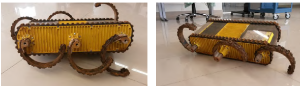
Figura 3: Problemas de locomoção apresentados no robô original.
