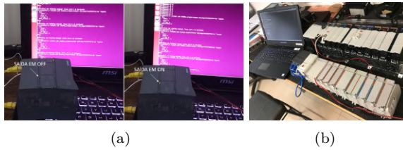
Figura 7: Testes de comunicação entre o ROS e controladores industriais.
