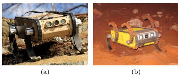
Figura 2: (a) Modelo RHex: Inspiração para o dispositivo de monitoramento de cavidades.
