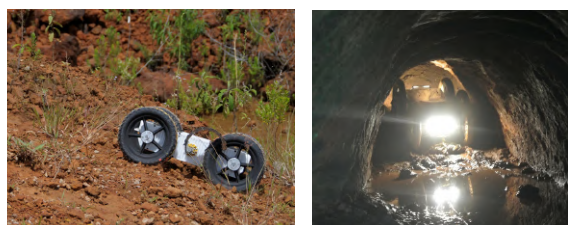
Figura 17: Testes de campo em terrenos não-estruturados inclinados e cavidades em área de risco.
