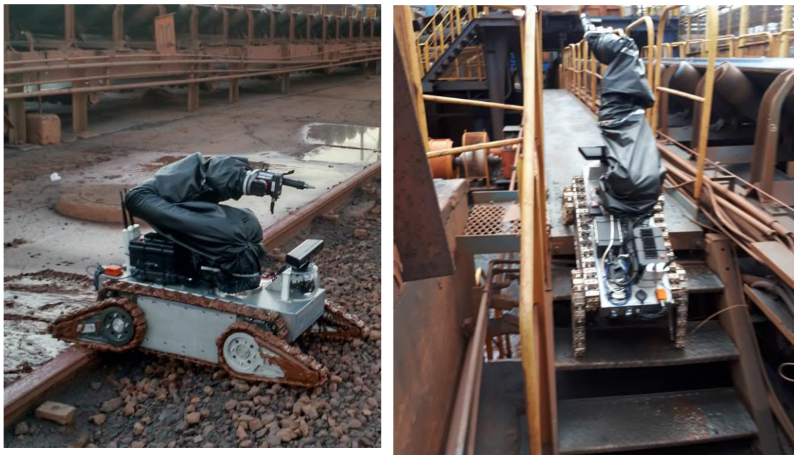
Figura 9 – Transposição de obstáculos com a plataforma robótica.
