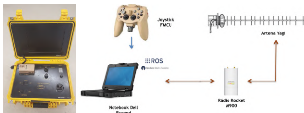
Figura 12: Bases de controle original (esquerda) e esquema da nova implementação (direita).
