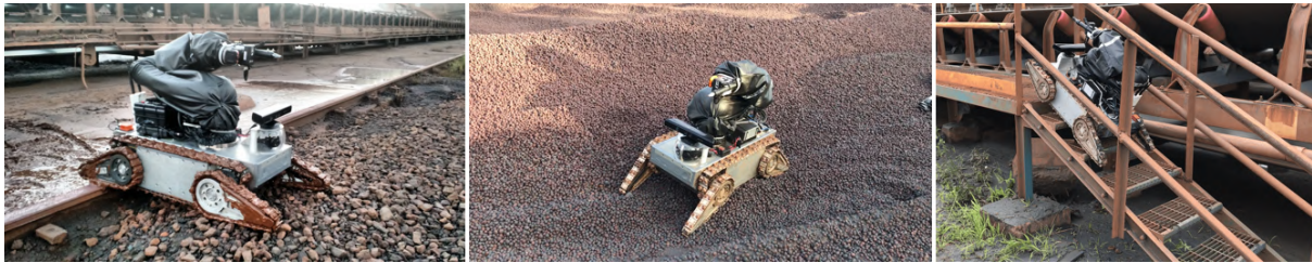
Figura 8: Plataforma móvel atravessando um trilho de trem, locomovendo-se em uma pilha de pelotas e escalando um lance de escadas.
