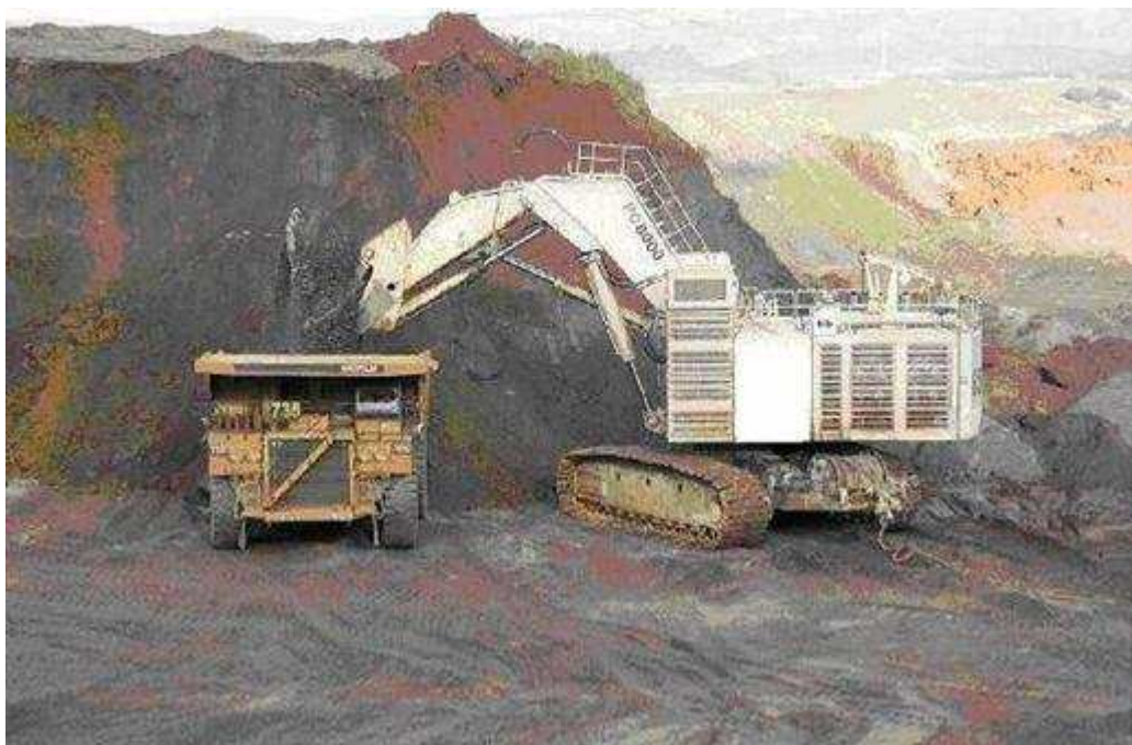
Figura 6: Equipamentos de carga e transporte
