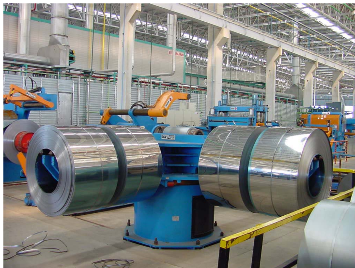
Fig. 3 – Bobinas blanks de largura l_i (geradas após o corte da bobina de largura L ).
