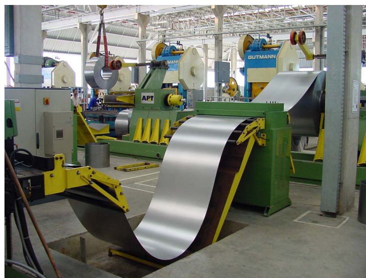
Fig. 4 – Corte da bobina blank na máquina Blanqueadeira dando origem aos blanks.
