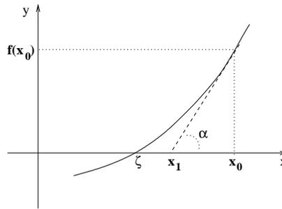
Figura 7: Interpretação geométrica do Método de Newton-Raphson
