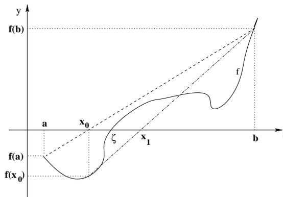
Figura 5: Interpretação geométrica do Método da Falsa Posição
