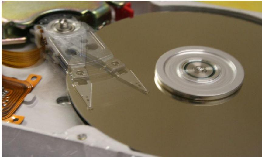
Figura 29: Um disco rígido sem a cobertura protetora, mostrando o movimento da cabeça de leitura e gravação
